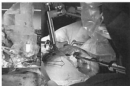
図 2. ROBODOC での大腿骨髄腔掘削
